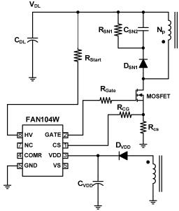
Figure 30. HV Startup Circuit
