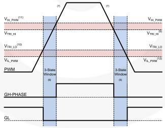
Figure 28. **PWM Threshold Definition**
