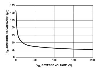
FIGURE 7. JUNCTION CAPACITANCE vs REVERSE VOLTAGE
