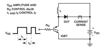
FIGURE 8. T<sub>rr</sub> TEST CIRCUIT
