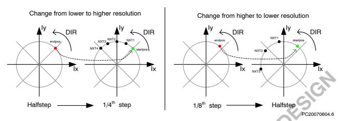
Figure 12. NXT-Step Mode Synchronization
