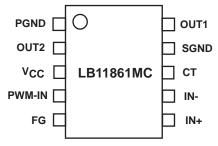
VCC : モータ系、制御系共通電源
