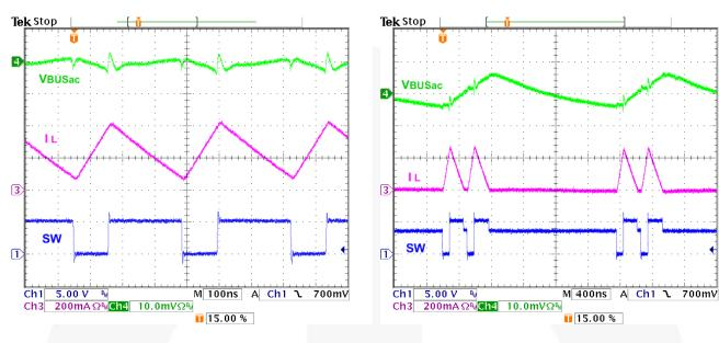
Figure 27. Boost PWM Waveform
