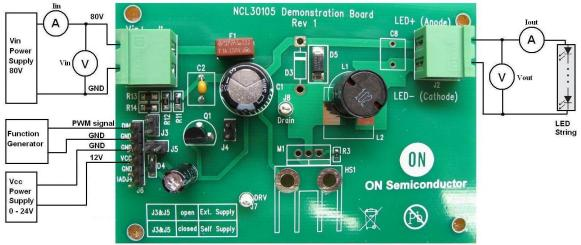
Figure 4 : Test Setup 3
