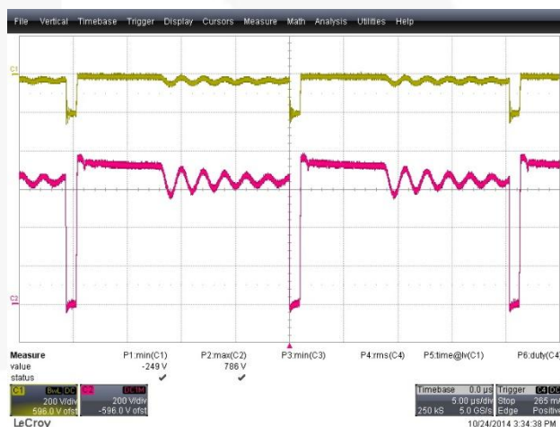
図 45. V DS =786 V、V DIODE =249 V、定常状態、全負荷時、 460 V AC (CH1 : V DIODE (200 V/div)、CH2 : V DS (200 V/div)、 時間 : 5 μs/div)
