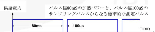
図9. SPM-IGBT の $R_{Jc}$  測定に使用される供給電力とサンプリングパルス波形の例
