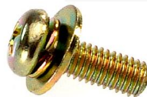
図4. セムスネジ (サイズ M3, スプリングワッシャー 5.0Φ, 平ワッシャー 7.5Φ)
