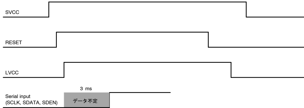
図 8. パワーオンリセット有効としない場合の電源シーケンス
