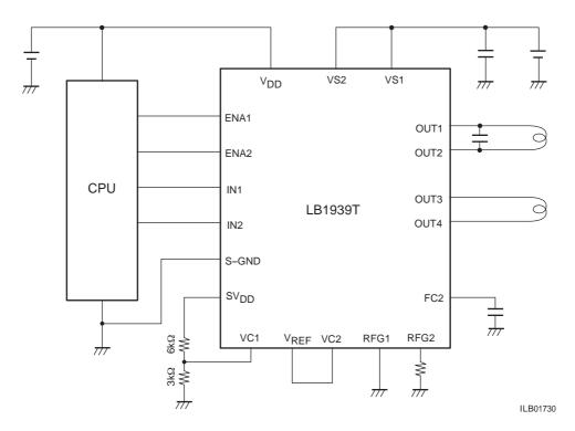
1chは、定電圧制御:OUT出力は、 $V_{DD} \times 3$ k $\Omega$  / (3k $\Omega$  + 6k $\Omega$ )  $\times$  1.95倍が出力される。 2chは、定電流制御:コイル電流は、 $V_{REF}$  / 4.5=0.2VでRFG電圧が制御される。 FC1はopen
