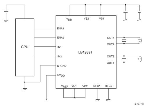
定電圧制御時:OUTは、V<sub>REF</sub>(0.9V)×1.95倍=1.75Vが出力される。 FC1, FC2はopen
