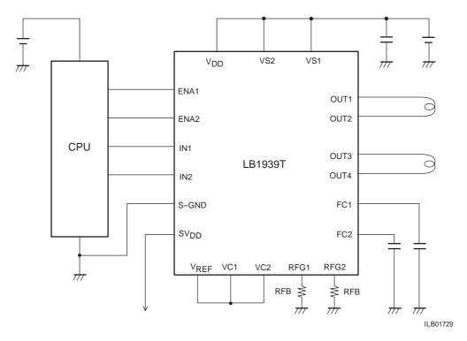
定電流制御時:コイル電流は、RFG電圧が $V_{REF}$  / 4.5=0.2V になるよう制御される。 よってRFB= $1\Omega$ 時は $I_{COII}$ =0.2V /  $1\Omega$ =200mAで定電流駆動となる。 それぞれの入力(ENA, IN)電圧とそれぞれの電源( $V_{DD}$ ,  $V_{S}$ )電圧の上下関係はない。 ex.  $V_{IN}$ =5V,  $V_{DD}$ =3V,  $V_{S}$ =2Vでの使用も可能である。
