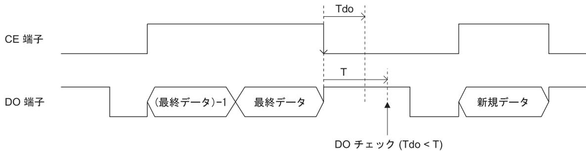
② DO 端子がデータ読み出し後、 $265 \text{ms}$  ( $T_{do}$ ) 以降で Low の場合
