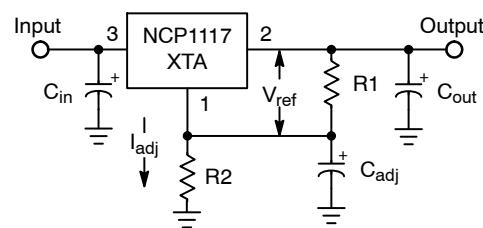
$$V_{out} = V_{ref} \left( 1 + \frac{R2}{R1} \right) + I_{adj} R2$$
