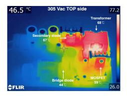
Figure 20.  $V_{IN}$  = 305  $V_{AC}$
