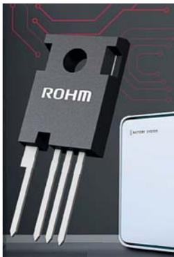
Die SiC-MOSFET-Serie **SCT3xxx xR** von **Rohm** beinhaltet drei 650- und drei 1200-V-Transistoren mit Trench-Gate-Struktur. Ihr TO-247-4L-Gehäuse mit vier Anschlüssen erhöht die Schaltleistung und reduziert laut Hersteller die Schaltverluste um bis zu 35 % gegenüber einem herkömmlichen TO-247N-Gehäuse.
